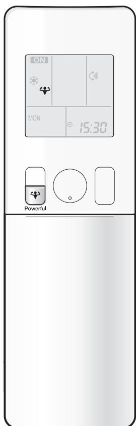
VÝKONNÝ režim rychle maximalizuje účinek chlazení (topení) v kterémkoliv provozním režimu. Můžete dosáhnout maximálního výkonu.
