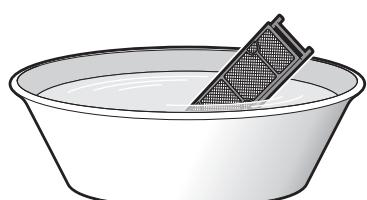
**2-2 Po umyti vytřeste zbývající vodu a nechte filtr uschnout mimo přímé sluneční světlo.**
